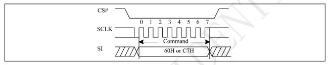
Figure 10-42a Chip Erase (CE) Sequence (QPI)
